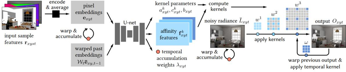
上图，首先提取出每个样本的内在表示 (embeddings)  $\mathbf{e}_{xyt}$ ，该步骤使用一个小的逐点网络 (pointwise network)。然后，我们对这些 embeddings 使用一个时序递归滤波器，使用自适应学习到的参数来传播帧之间的信息，然后将每个像素的 embeddings 分别取平均。
