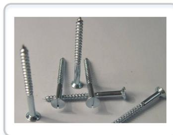
自攻螺钉用于紧固连接两个薄的金属构件，使之成为一件整体。构件上需要事先制出小孔，由于这种螺钉具有较高的硬度，可以直接旋入构件的孔中，使构件孔中形成相应的内螺纹 [2]。
