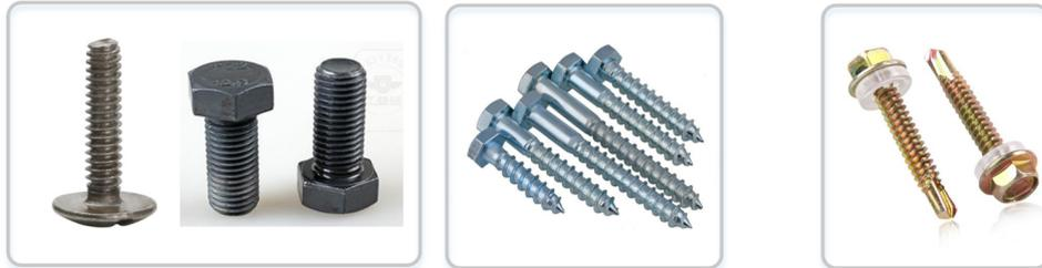
机螺钉也叫机械螺钉，螺纹比较密；相比于自攻螺钉有一个尖头，机螺钉的前后端粗细一致。由于螺纹比较密，机螺钉可以比自攻螺钉拧得更紧，但由于没有尖头，所以需要提前打孔螺纹。
