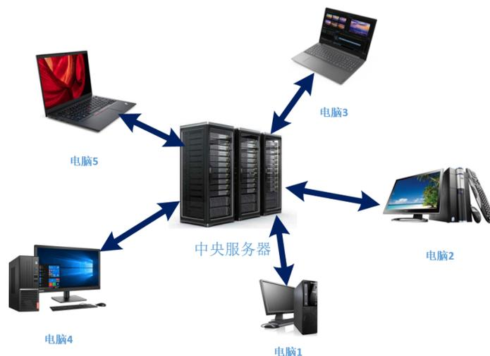
而分布式版本控制理论上并没有中央服务器，如果使用客户端提取文件则需要把整个代码仓库镜像完整拷贝下来，每个人都保存一个完整的版本库。如果某一个服务器出现了故障，就可以使用任何一个本地仓库来恢复。在实际操作时，Git 也会拟定一个中央仓库，而当中央仓库出现错误时，则开发者可以新建一个新的中央仓库，然后将本地仓库同步到新的中央仓库上：
